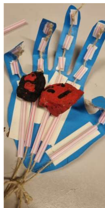
Figura 1> Distribuição das palhinhas na palma da mão artificial.
